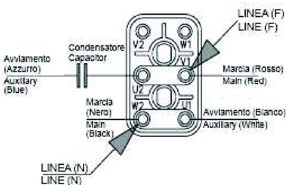
Motore monofase con termico (MM1)
