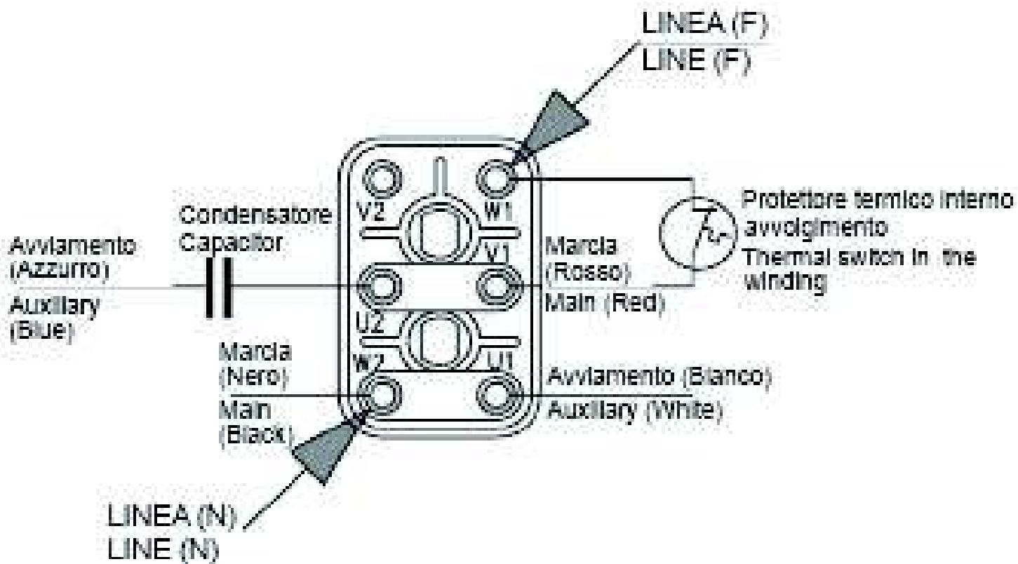
**Motore monofase con disgiuntore elettronico
