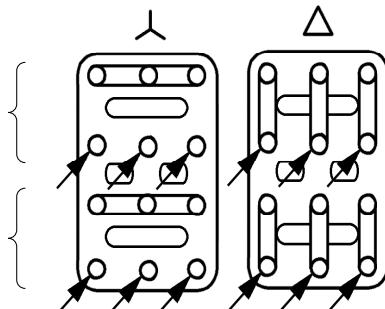
Collegamento per motori a 2 velocità, 2 avvolgimenti separati, 6 morsetti
